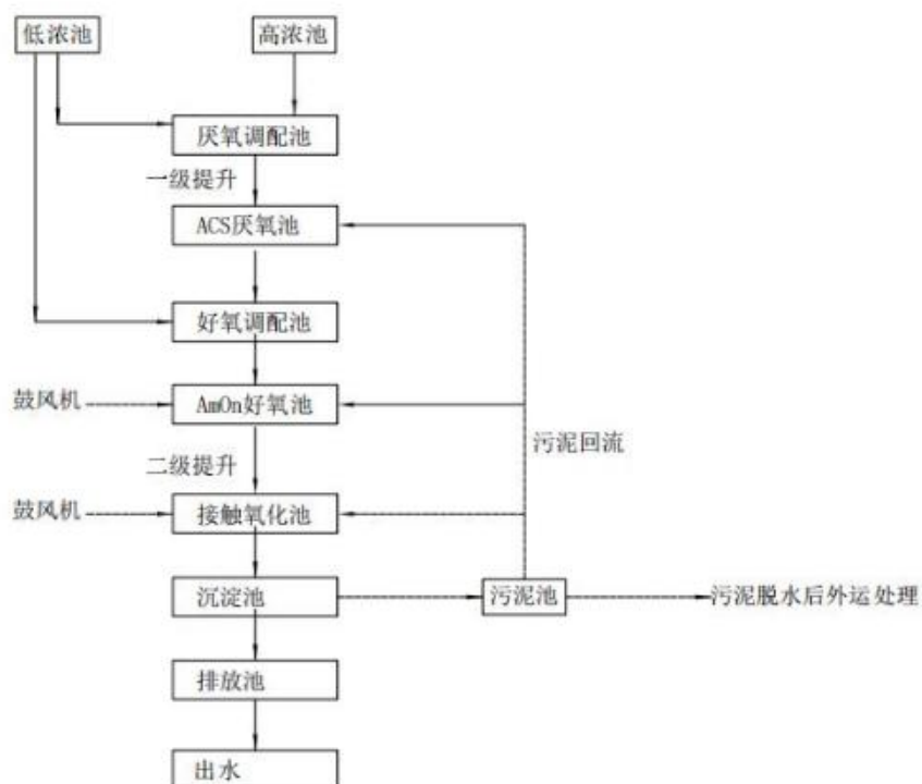
图 4.1-2 废水处理工艺流程图
